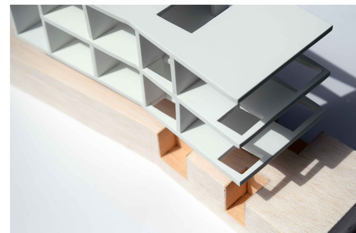
MAQUETA. Vista lateral. Huecos en medianera Este (iluminación sótano 1 y ascensor).
